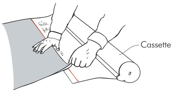
3. Schutzband abnehmen. Mit dem Bild sichtbar nach oben anbringen und das Bild entlang der roten Linie positionieren.
