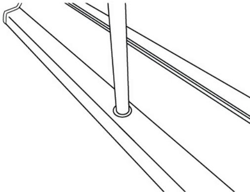
3. Die Grafik aus dem Gehäuse ziehen und die Plastikspitze im oberen Profilschlitz mittig positionieren. (Tipp: Hinter das System gehen und beim Herausziehen der Grafik das System schräg nach hinten kippen, so dass eine bessere Möglichkeit zum einhängen des Profils entsteht.)
