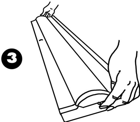
3. Durch gleichzeitiges Betätigen der Arretierungen rechts und links öffnen Sie die Klappe des Systems.
