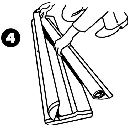
4. Nun können Sie die Austauschrolle entnehmen und die neue einsetzen. Hierbei ist darauf zu achten, dass der Metallstift erst nachdem Sie das System wieder geschlossen haben heraus zu ziehen ist!
