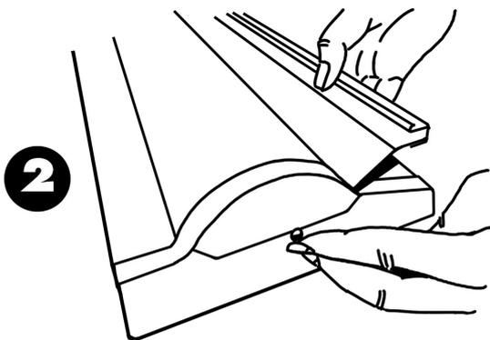
2. Ziehen Sie den Druck soweit aus dem System (ca. 10 cm) bis der Metallstift bis zum Kopf in der Öffnung verschwindet. Jetzt ist der Federmechanismus blockiert.
