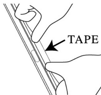
6. Gehäuse durch drücken der Tasten auf beiden Seiten öffnen und die innenliegende Rolle herausnehmen.
