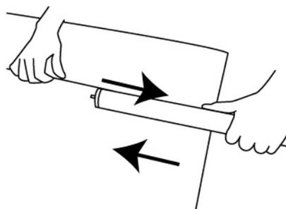
8. Die Rolle mit der Grafik in das Gehäuse setzen und die restliche Grafik außen liegen lassen. Gehäusedeckel schließen und beide Schrauben wieder anziehen.
