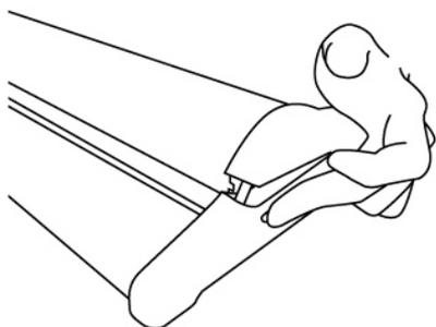
7. Unteren Keder in den Schlitz der Rolle seitlich hineinschieben.
