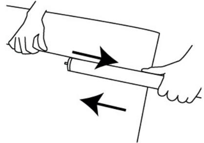
8. Die Rolle mit der Grafik in das Gehäuse setzen und die restliche Grafik außen liegen lassen. Gehäusedeckel schließen und beide Schrauben wieder anziehen.
