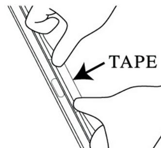
6. Gehäuse durch drücken der Tasten auf beiden Seiten öffnen und die innenliegende Rolle herausnehmen.
