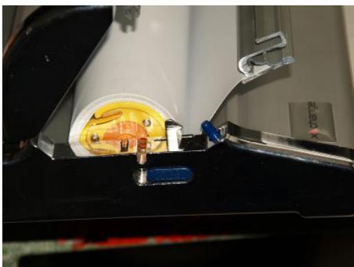
4. Rolle wieder in das Gehäuse einlegen und dieses schließen.
