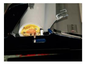
4. Rolle wieder in das Gehäuse einlegen und dieses schließen.
