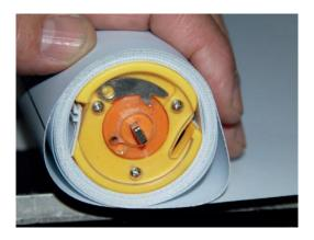
3. Nach jeder Umdrehung arretiert ein Metall-Pin die Rolle, damit keine Spannung verloren geht.
