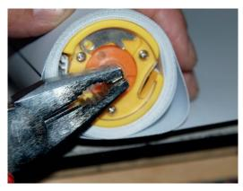
2. Die Grafik bleibt um den Kern gewickelt. Den Splint mit einer Zange zehn mal im Uhrzeigersinn drehen.
