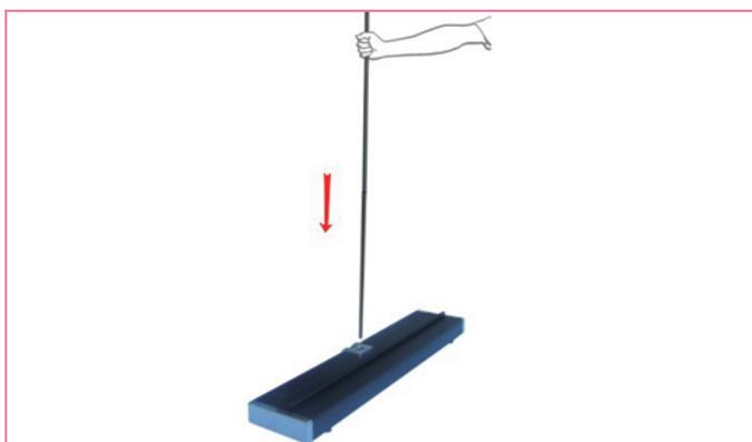
2. Stecken Sie die Stange in das dafür vorgesehene Loch im Gehäuse
