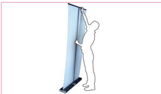
3. Ziehen Sie die Grafik gleichmäßig aus dem Gehäuse und positionieren Sie die Plastikspitze mittig im Profilschlitz. (Tipp: Hinter das System schräg nach hinten kippen – so kann das Profil leichter einsehänat werden.)
