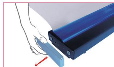
6. Entfernen Sie die Seitenkappe auf der rechten Seite des Gehäuses
