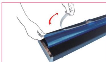
4. Entfernen Sie das doppel-seitige Klebeband von der PVC Folie
